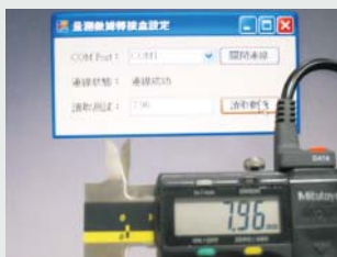
圖1 電腦連線傳輸量測數據圖
